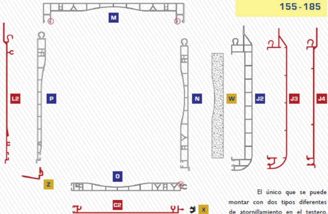
El único que se puede montar con dos tipos diferentes de atornillamiento en el testero.
